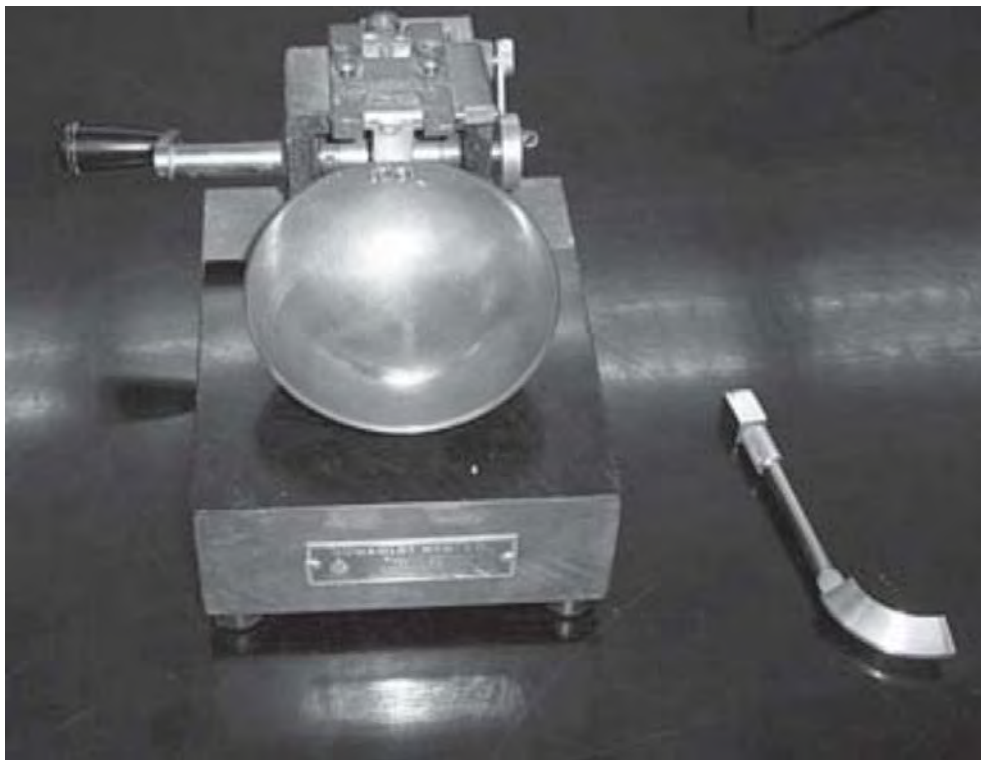
Fig: 1.5.4.1 Casagrande Liquid Limit Apparatus
